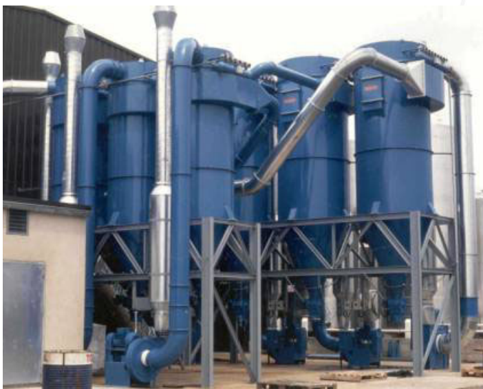
SimPact 4T, импульсно-реактивный фильтр для сбора мраморно-стекло- полиэфирной пыли завод S.T.D. во Франции
