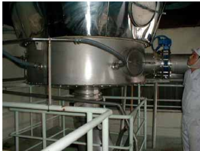
Вологе днище Simatek гарантує легке розвантаження, навіть у випадку з'єднання порошку.
