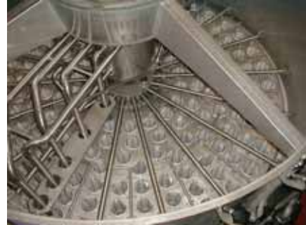
SimPulse 3C, індексація системи мундштуків для вологого очищення фільтрових рукавів всередині, так само як секції чистого повітря
