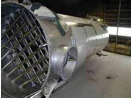
SimPact 4T, бризговий циліндр для вологого очищення секції чистого повітря
