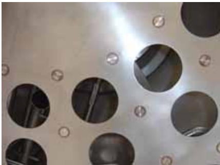
SimPulse 3C, лист труби з інтегрованими CIP-мундштуками для очищення фільтрових рукавів зовні та поверхні продукта в камері фільтра
